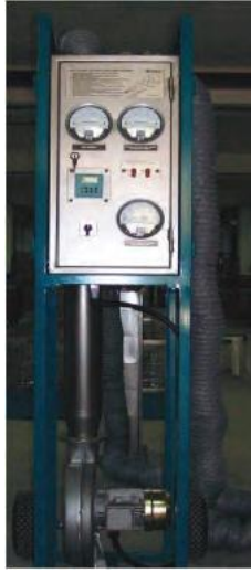
Şekil 6. Hava kanalı sızdırmazlık test cihazları
