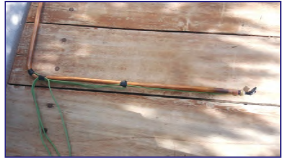
Şekil 2. Üretilen ısı borularından birinin görünümü
