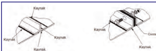
Şekil 9. Kabul edilebilir kaynaklı kanal bağlantıları
