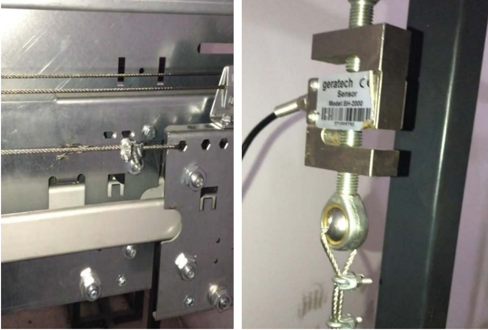
Resim 11. Statik testi yapılan kat kapısı kilitleme tertibatı
