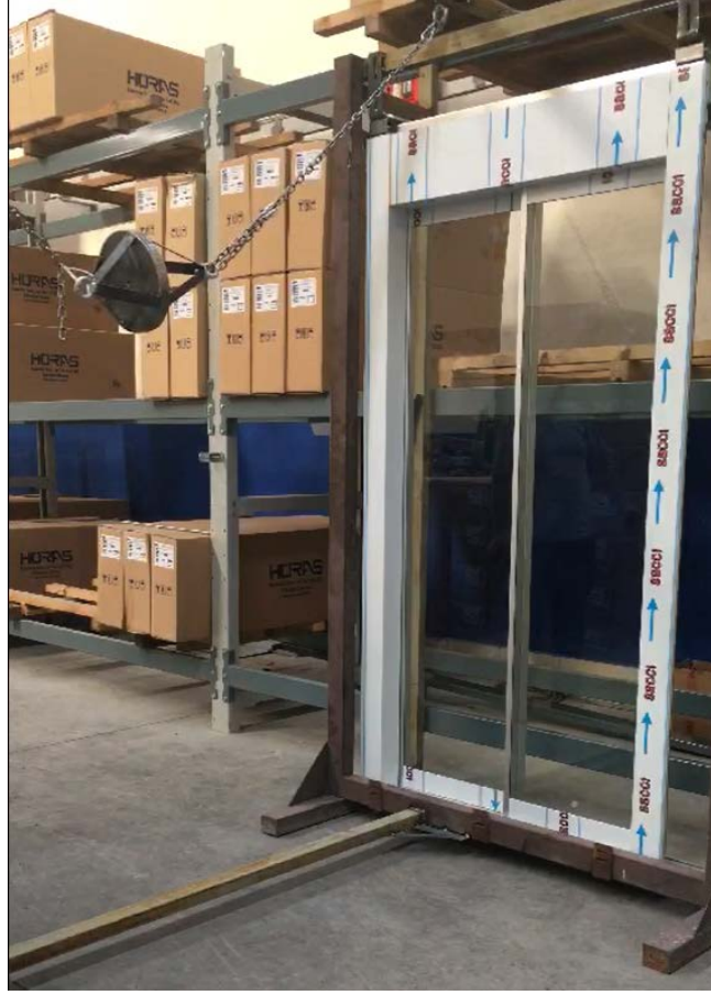
Resim 19. H=800 mm Sert darbe deneyi düzeniği görüntü
