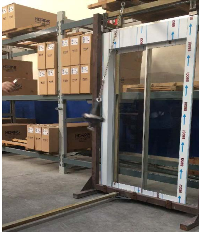
Resim 20. H=800 mm Sert darbe deneyi, deney anı görüntü
