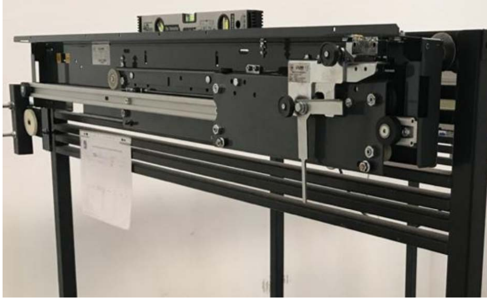
Resim 8. Test edilecek kat kapısı kilitleme tertibatı
