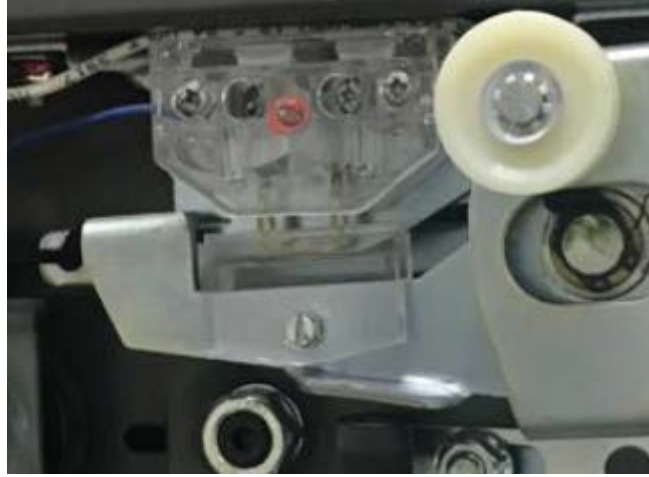
Resim 9. Test edilecek kat kapısı kilitleme tertibatı kilitleme elemanı 7 mm içeri girme durumu
