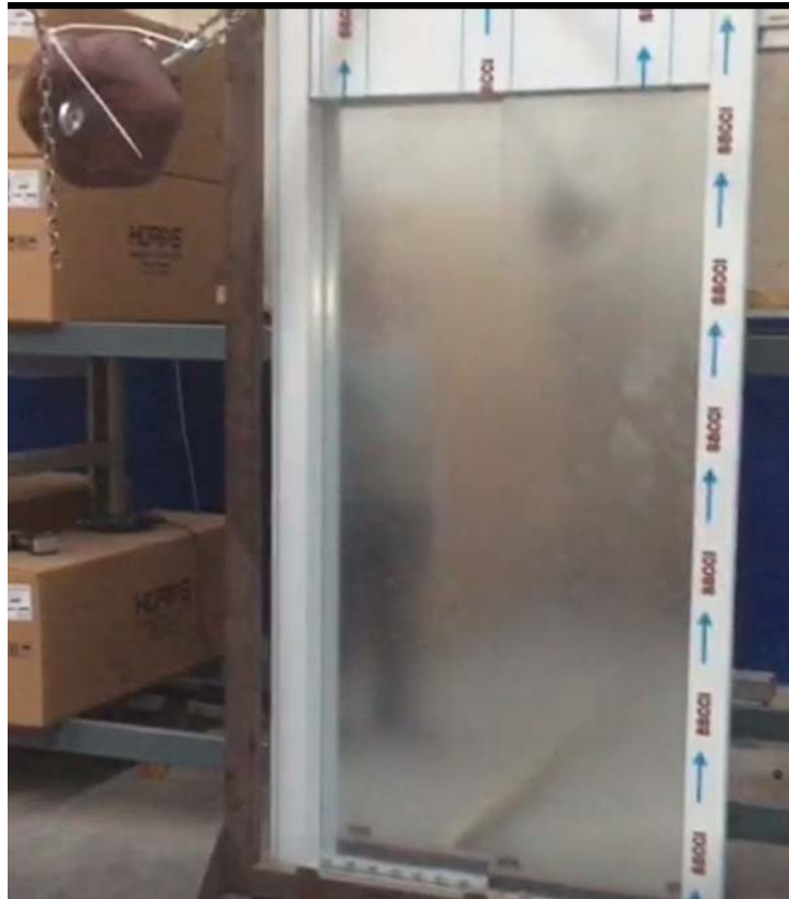
Resim 16. H:800 mm yumuşak darbe deney öncesi
