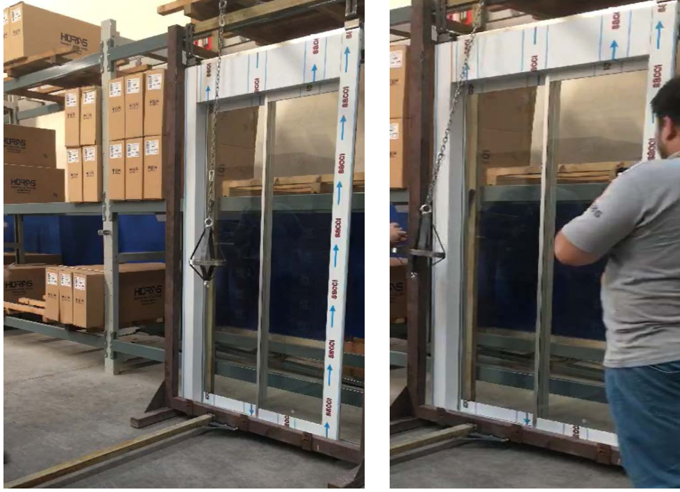
Resim 21. H=800 mm Sert darbe deneyi, deney sonrası görüntü
