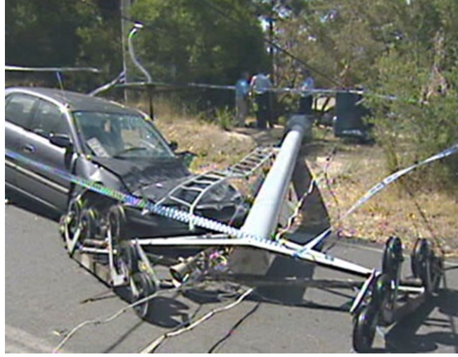
Şekil 2 Halatlı Taşıma Sistemindeki Direk Kazası
