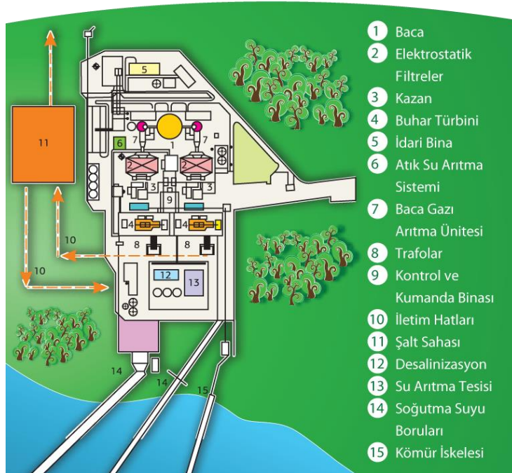
Şekil 2.2.b İSKEN-Sugözü Enerji Santrali Genel Yerleşimi
