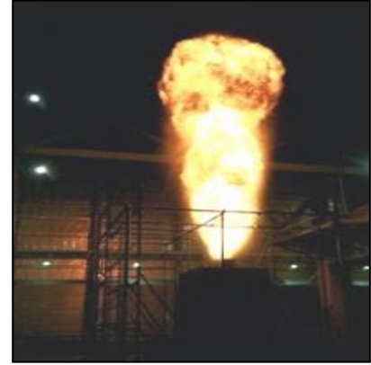
Fotoğraf 20.6 Yağ Kaçağı Sonucu Yangın
