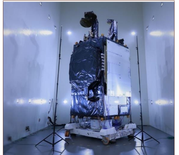
Şekil 6. TÜRKSAT 6A Uydusu Akustik Testi
