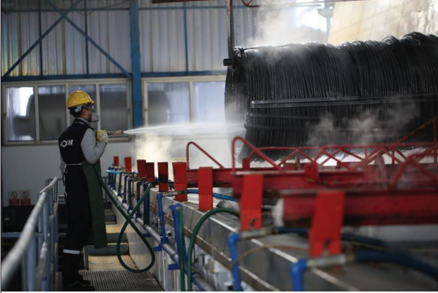
Şekil 3. Çinko-Fosfat Kaplama Tesisi
